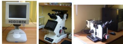
Microscopio para analisis invertido con camara digital *Olympus GX51*
