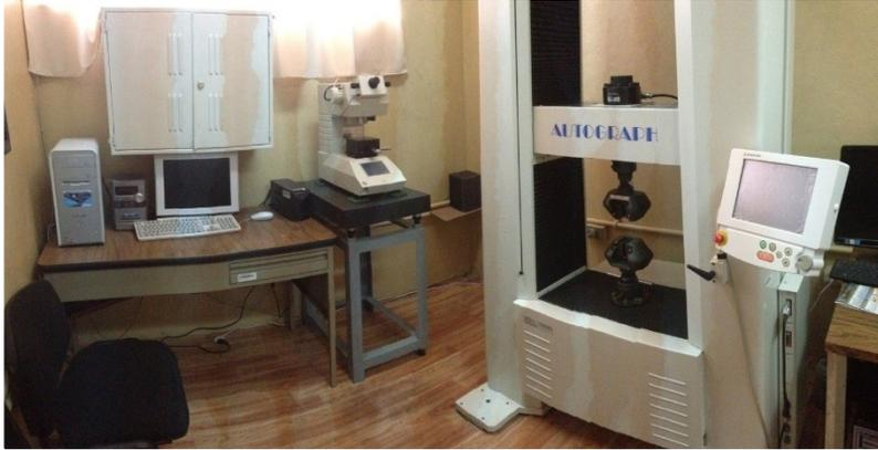
Máquina universal de ensayos mecánicos
