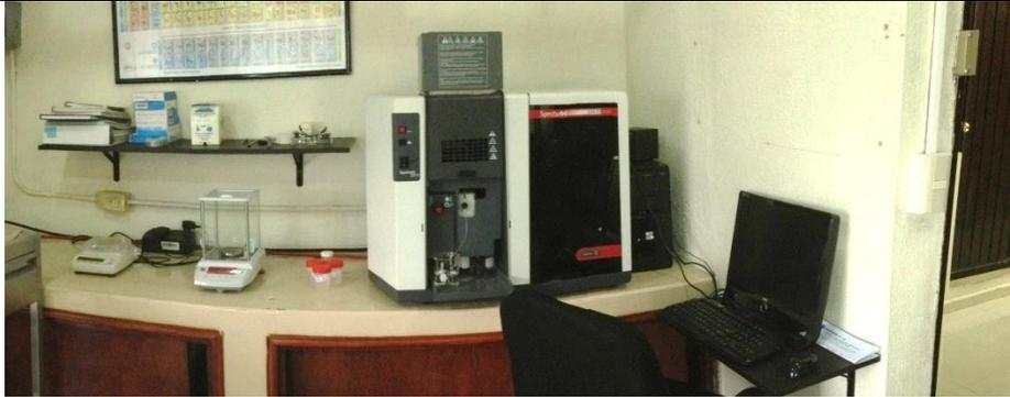
Espectrómetro de absorción atómica (AAS) *Spectra 220FS™*
